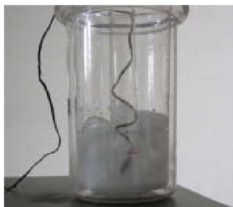
図2 水の冷却装置 試験管には、温度測定用のセンサを入れてある。
