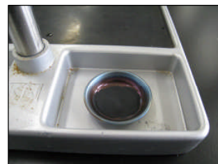
図2 早く冷ますための工夫 鉄製スタンドを利用する。
