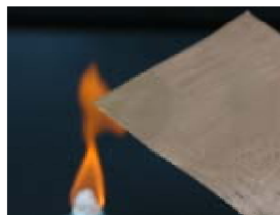
銅板の端を加熱している様子
