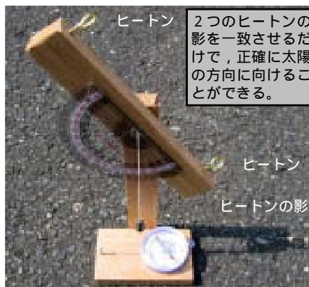
図2 簡易高度方位測定器
