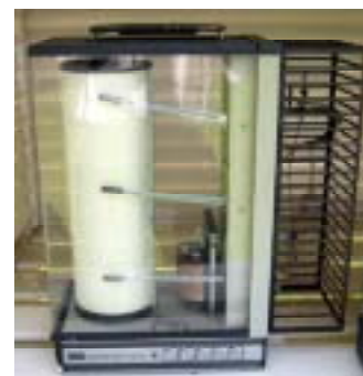
図1 自記温湿度気圧計 気温の変化をとらえやすく、 長期の観測も容易である。
