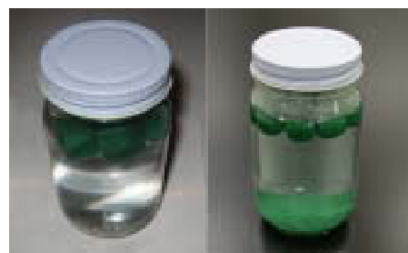
図2 吸水スポンジでのモデル実験 砂やれきが丸くなることを簡単に再現できる。振る前(左)と後(右)
