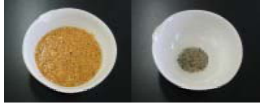
図5 鹿沼土の洗い出し 園芸店等で手に入りやすく、わんがけにより鉱物を取り出すのも簡単である。
