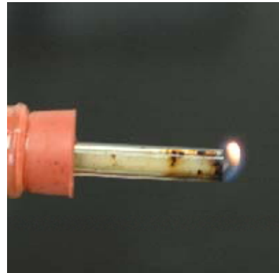
木ガスが燃焼している様子
