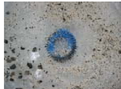
図6 磁石につく鉱物 3cm 磁鉄鉱を磁石で集めておくと、顕微鏡で見つけるのが簡単である。
