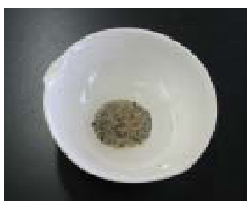
図3 鹿沼土の洗い出し 初めに水を少量入れ、浮いている軽石をできるだけつぶしておく と2回目以降の作業がしやすい。
