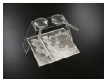
図1 簡易実体鏡 土地の変化による地形の特徴を観察しやすい。
