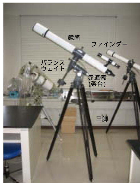
図1 天体望遠鏡の構造
