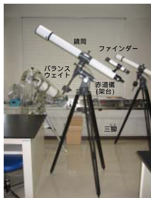
図1 天体望遠鏡の構造 中央は屈折式、左奥は反射式望遠鏡である。
