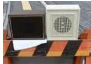
そこで、ここでは、電子メトロノームを使用し、空気中を音が伝わる速さを、より正確に測定する実験を行った。
