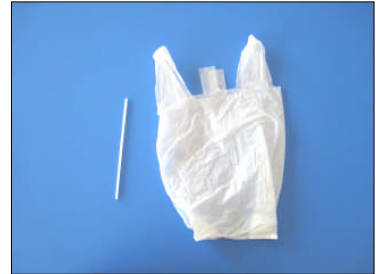
図1 ストロー（低密度ポリエチレン）と乳白色のレジ袋（高密度ポリエチレン）
