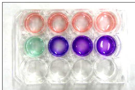
図3 8個のセルを使い4種混合指示薬で調べた結果
