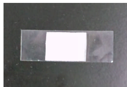
図1 スライドガラス上の寒天を含むクッキングペーパー
