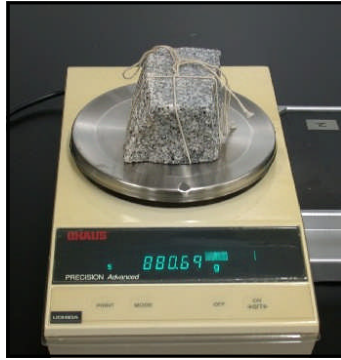
図4 体積の精密測定 電子天秤を用いると、岩石の体積を簡単かつ精密に測定できる。
