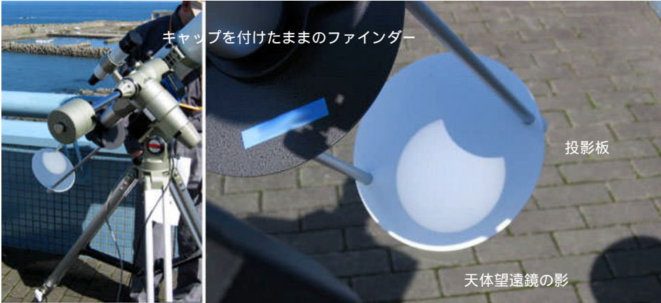
図2 太陽の観察 図3 太陽の導入 太陽を直接見たり，天体望遠鏡で直接のぞかない！ ファインダーはキャップで必ずふさいでおく！ 天体望遠鏡の影が最も小さくなるようにすると，投影板に像が見えてくる。
