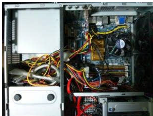
パーソナルコンピュータの内部
